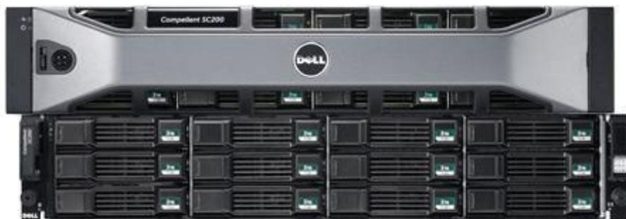
Un boîtier SAS 6 Gbit/s au format 2U prenant en charge jusqu'à 24 disques durs 2,5" ou des options « tout-Flash » ou Flash hybrides permettant un large choix d'options de stockage dans un seul châssis.
